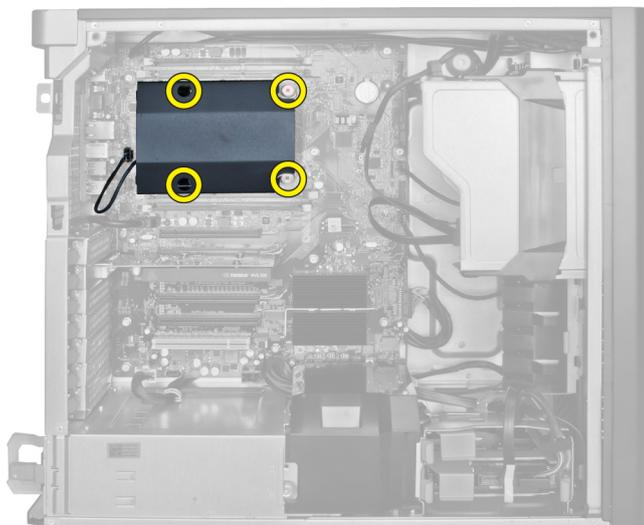
5. Erga o dissipador de calor e remova-o do computador.
