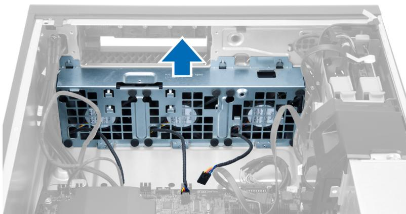
13. Retire os pinos de borracha para remover os ventiladores do conjunto do ventilador do sistema.
