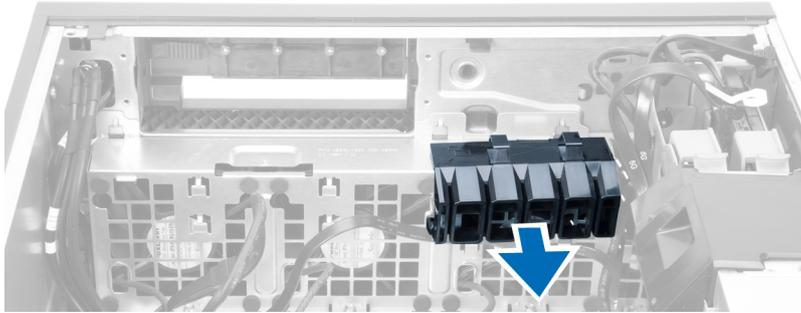
10. Desconecte os cabos do ventilador do sistema da placa de sistema.
