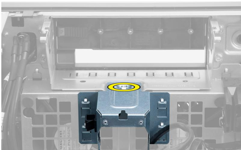
5. Pressione as travas na outra extremidade da placa metálica para liberá-la.
