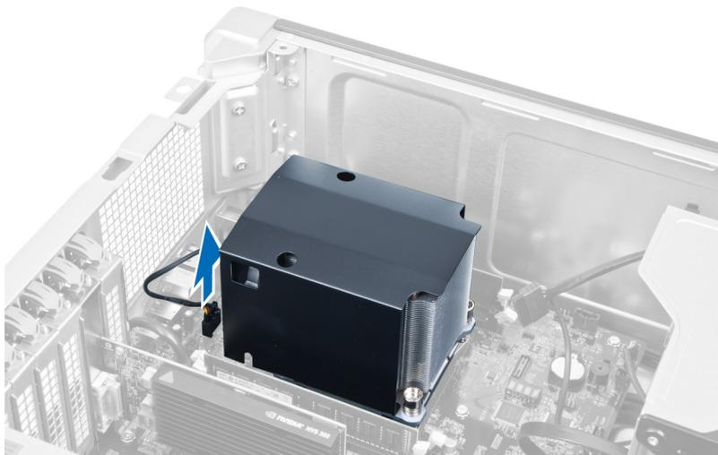
4. Solte os parafusos que prendem o dissipador de calor.
